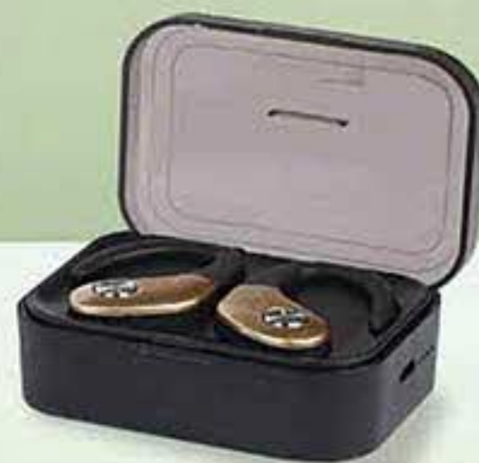
ZY-D1对耳(按键片) 杰里方案6936D 充电仓602535(500mAh) 对耳501012(40mAh有保护) 对耳501015(50mAh无保护)
