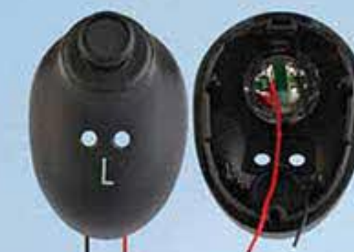
T08-1 装TWS前壳 8厘铜环加电子线
