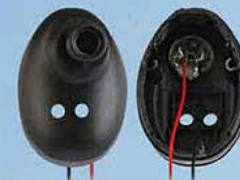
T06-16 装TWS前壳 6厘金属加电子线
