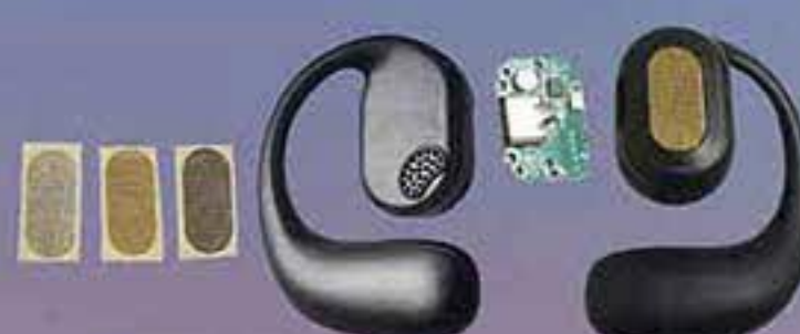
Dm-1158 单耳蓝牙 (专利产品) 贴片彩铜网、出音孔不贴膜(专利号:2024302145033) 电池:601225 (130mAh) 喇叭:16mm 充电口:Type-C
