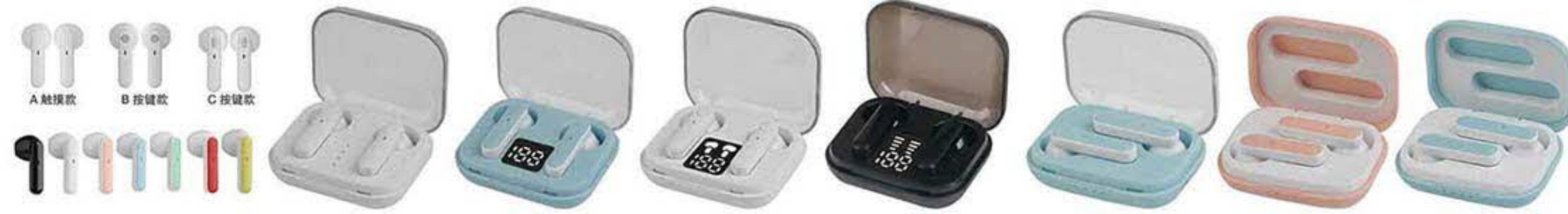
(耳壳ABC款可选配; 外观专利) BM-1367 BM-1369 BM-1387 BM-1388 耳壳电池最大尺寸: 401010 整套磁铁规格: 4x5x2.0mm 耳壳喇叭尺寸: \Phi 10mm 充电仓电池最大尺寸: 602030 充电仓外壳尺寸: 长60 x 宽50 x 高22mm 充电接口: micro BM-1396 (配透明上盖; 卡位盒) BM-1386 (配实色上盖; 磁吸盒) 耳壳喇叭尺寸: \Phi 10mm 耳壳电池最大尺寸: 401010 充电仓电池最大尺寸: 701530 充电仓外壳尺寸: 长60 x 宽45 x 高22mm 整套磁铁尺寸: 4x5x2.0mm 充电接口: Type-C
