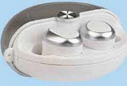
ZY-D3对耳(按键片) 磁铁5*4*2(4个) 对耳401015(40mAh) 充电仓602535(500mAh)
