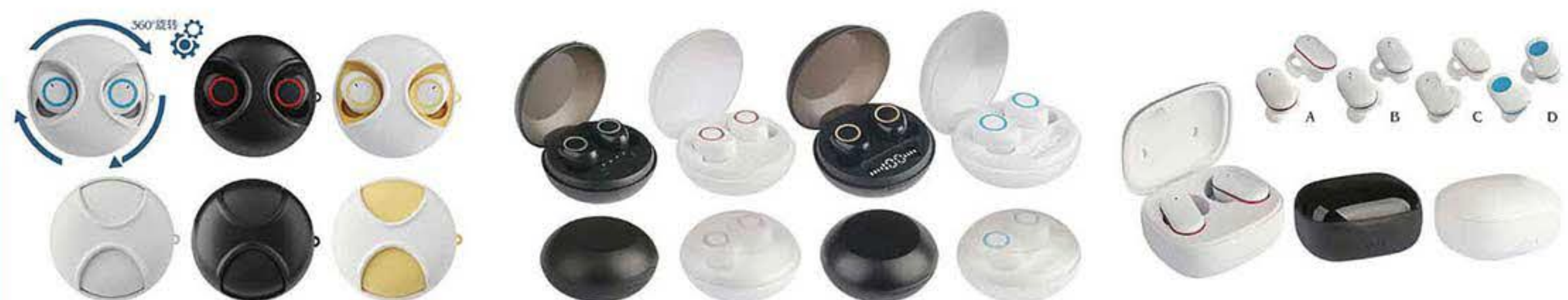
BM-1385 A触控款, B按键款(TWS耳机外壳; 外观专利) 耳壳电池规格: 501015 耳壳喇叭尺寸: \Phi 10mm 充电仓外壳尺寸: 宽66 x 高36mm 充电仓电池最大尺寸: 602030 全套磁铁规格: 4x5x2.0mm 充电接口: micro
