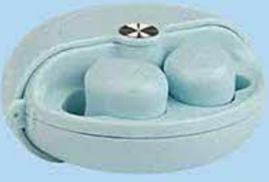
ZY-D3对耳(触摸片) 磁铁5*4*2(4个) 对耳401015(40mAh) 充电仓602535(500mAh)
